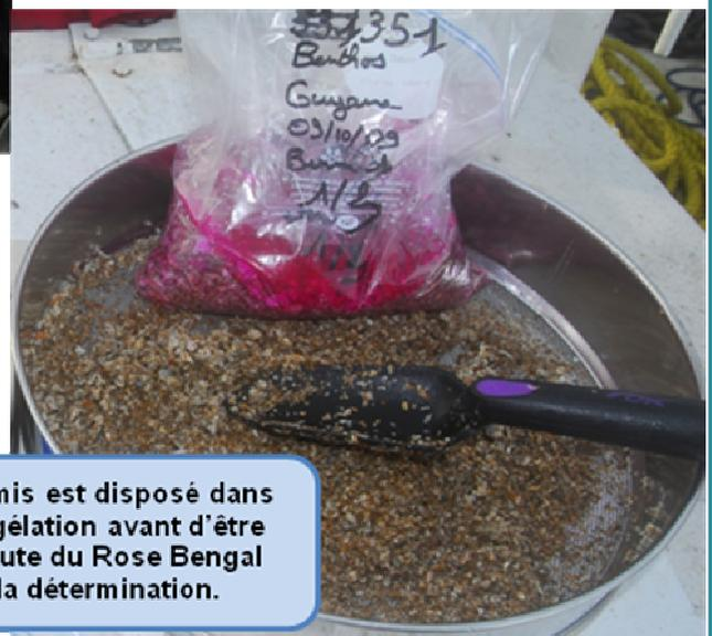
(4) Le refus de tamis est disposé dans des sacs de congélation avant d'être formolés. On ajoute du Rose Bengal pour faciliter la détermination.
