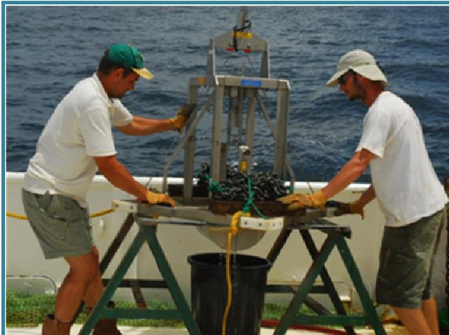
(1) La benne Smith Mac Intire, d'une surface de 0,1 m<sup>2</sup> est maintenue ouverte lorsqu'elle est sous tension. Une fois sur le fond, elle se referme automatiquement.
