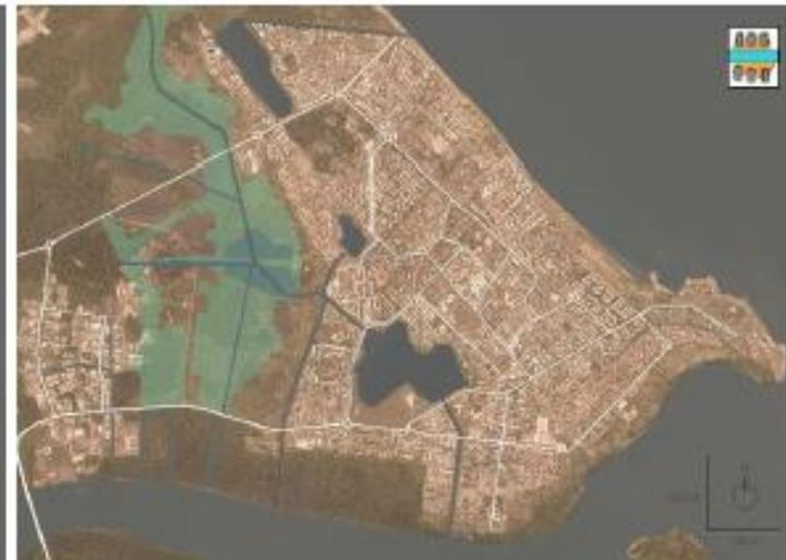
La création d'un canal principal et d'un 4<sup>e</sup> lacs permet le drainage de la zone d'études vers le fleuve Kourou.
