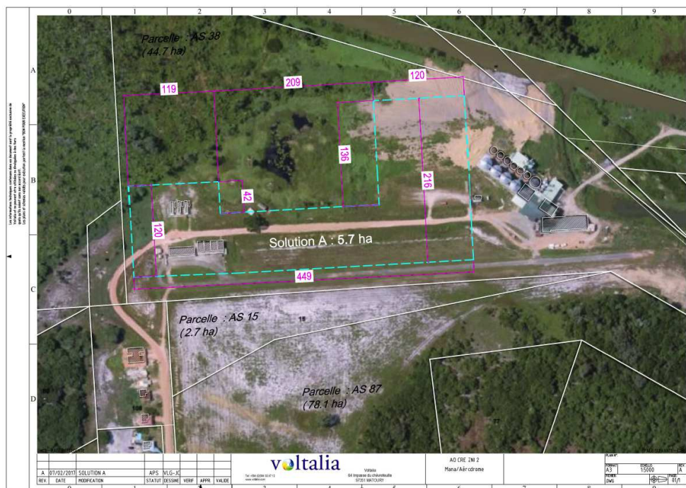
Figure 31 : Schéma d'implantation étudié pour la variante n°2 (sources : VOLTALIA, Geoportail)
