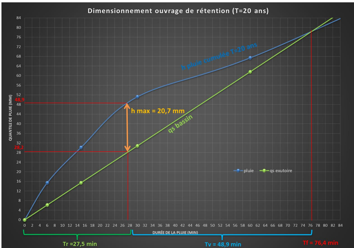
Figure 21 : Dimensionnement graphique de l'ouvrage de rétention
