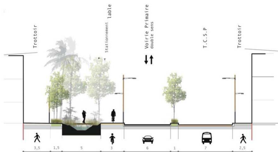
Figure 5 : Coupe transversale du projet de la voirie principale
