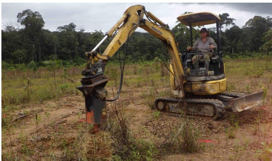
**PHOTO 22 : FOREUSE POUR LA REALISATION DES TROUS DE PLANTATION**
