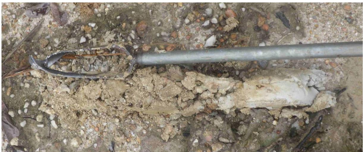
**PHOTO 12 : PRESENCE DE KAOLIN EN PROFONDEUR (SOCLE COMPACT A 30 CM DE PROFONDEUR)**
