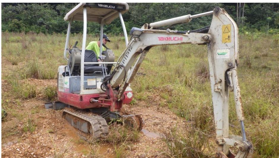
**PHOTO 23 : MINI-PELLE POUR REALISATION DES TROUS DANS LES ZONES DE CAILLOUX**
