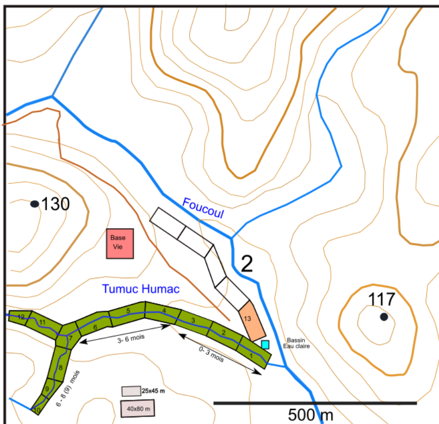
Phase 2 : Début exploitation flat droit crique Foucou, bassin eau claire
