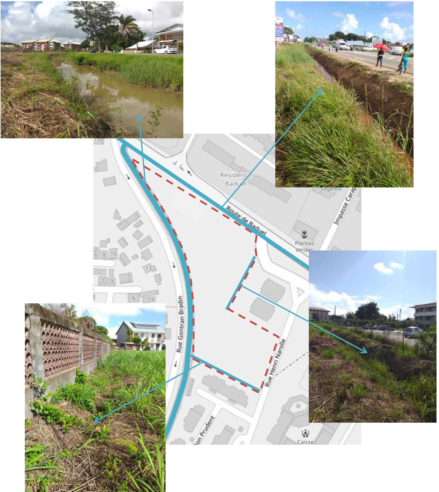
Figure 34 : Identification des réseaux d'eaux pluviales existants autour des parcelles
