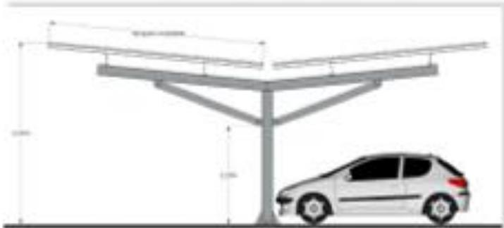
Nota : une gouttière centrale sera installée afin d'optimiser le traitement des eaux pluviales
