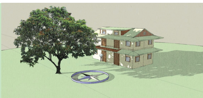
Schémas 3 : Protéger la façade ouest d'un bâtiment
