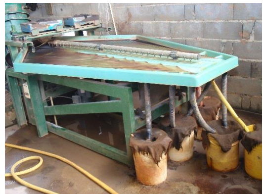
> Table à secousses d'Espérance : traitement gravimétrique du minerais
