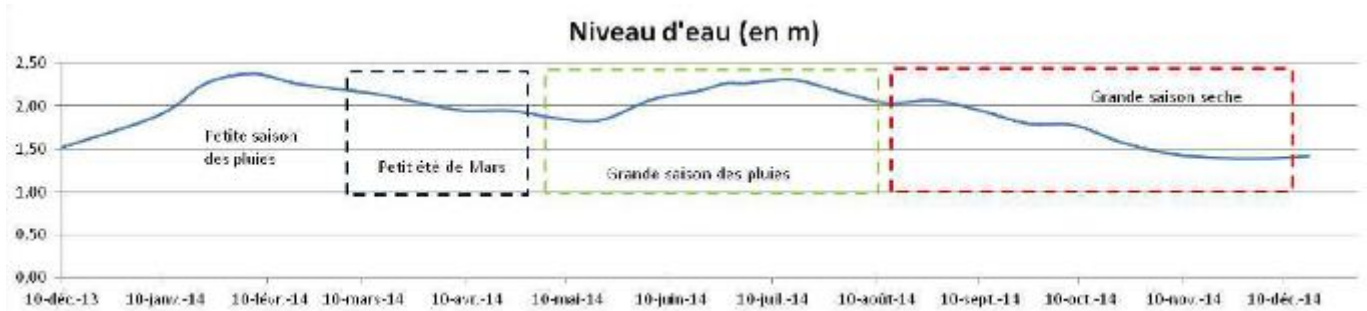
Figure 57 : Evolution du niveau d'eau mesuré sur l'échelle limnimétrique de la Roche Nicole de janvier à décembre 2014
