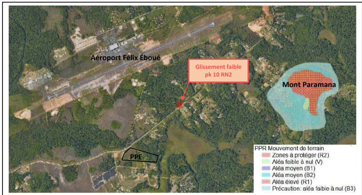
Figure 34 : Carte des glissements de terrain et PPRMVT dans la zone de projet - (BRGM-DEAL)
