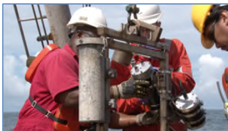
Photos 31. Carottier-boîte équipé du système de caméra vidéo déclenchée par la pression
