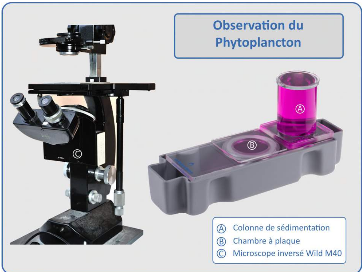
Figure 110. Chambre à plaque Hydrobios® pour l'observation du phytoplancton au microscope inversé et sa colonne de sédimentation utilisée pour les échantillons d'eau
