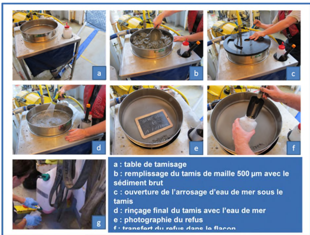
Photos 30. Équipement de filtration et mode opératoire d'échantillonnage du peuplement macrobenthique
