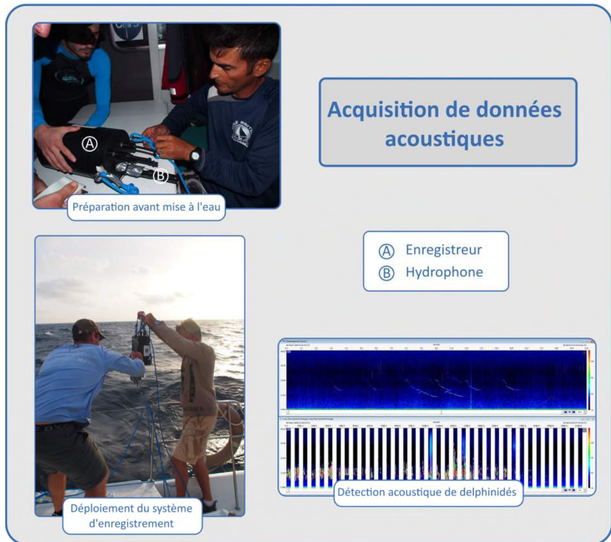
Photos 35. Opérations de mise à l'eau, retrait et nettoyage de l'enregistreur acoustique RS-ORCA
