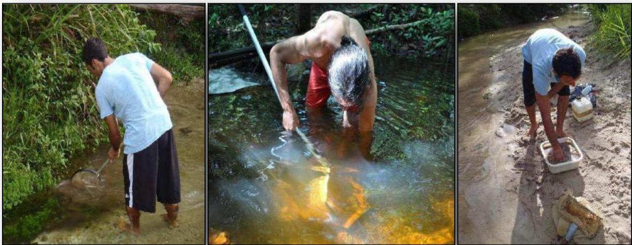
Figure 5: Représentations photographiques de l'échantillonnage de la macrofaune benthique à la drague à sédiments (à droite) et au filet troubleau (à gauche et au centre) (source Hydreco).
