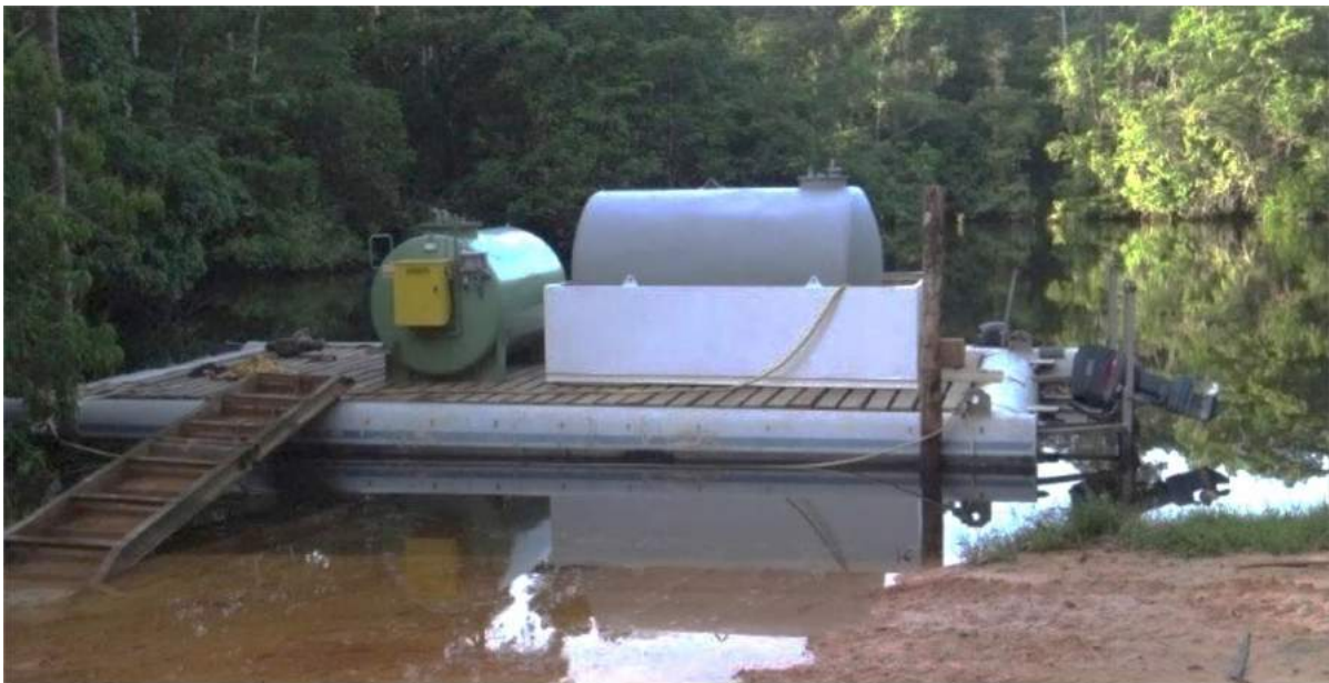
Figure 54 : Barge flottante équipée des 2 citernes
