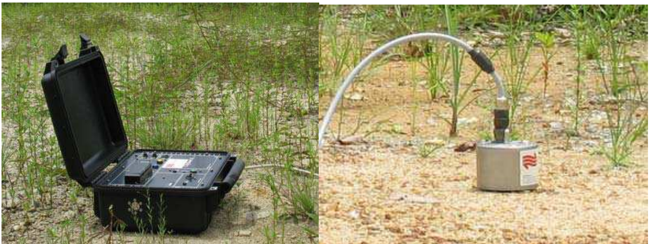
Figure 1 : Exemple de chaîne d'acquisition ( à gauche : centrale d'acquisitions CityShark / à droite : sismomètre Lennartz) .
