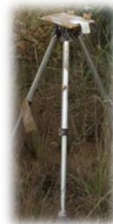
Figure 2 : Trépied métallique, support du bac à eau
