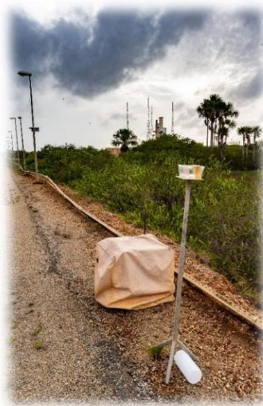
Figure 1 : Bac à eau sur son trépied métallique et SPM Honeywell sur le chemin de ronde
