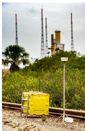
Figure 6 : SPM mobile installé en champ proche
