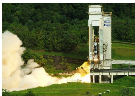
Figure 8 : Essai de mise à feu du spécimen P120 au BEAP le 16 juillet 2018 à 9h37 locale
