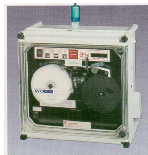
SPM Honeywell en cours de mise en place (à gauche : SPM dans son boîtier de protection – à droite : SPM sans protection)
