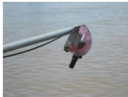
Figure. Mesure de la réflectance avec un Spectroradiomètre FieldSpec réalisées alternativement.
