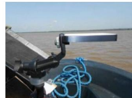
Figure. Mesure de la réflectance avec un Spectroradiomètre FieldSpec réalisées alternativement.
