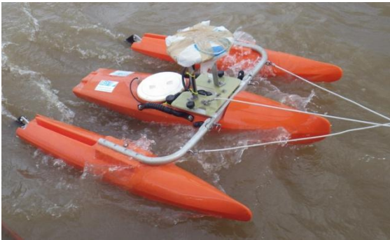
Figure. ADCP RiverRay 600 kHz -Teledyne RDI à effet doppler et jaugeage dans la section de CB.
