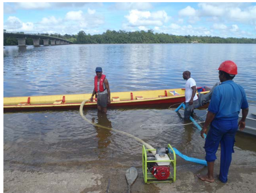
Tests de flottabilité sur une pirogue, pour vérification de sa conformité à l'arrêté du 17 octobre 2013
