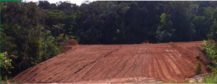
> Verses à stérile enherbée sur la mine Espérance. A gauche, état après terrassement. A droite, état après enherbement
