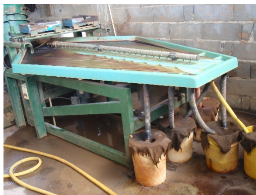
> Table à secousses Espérance : traitement gravimétrique du minerai
