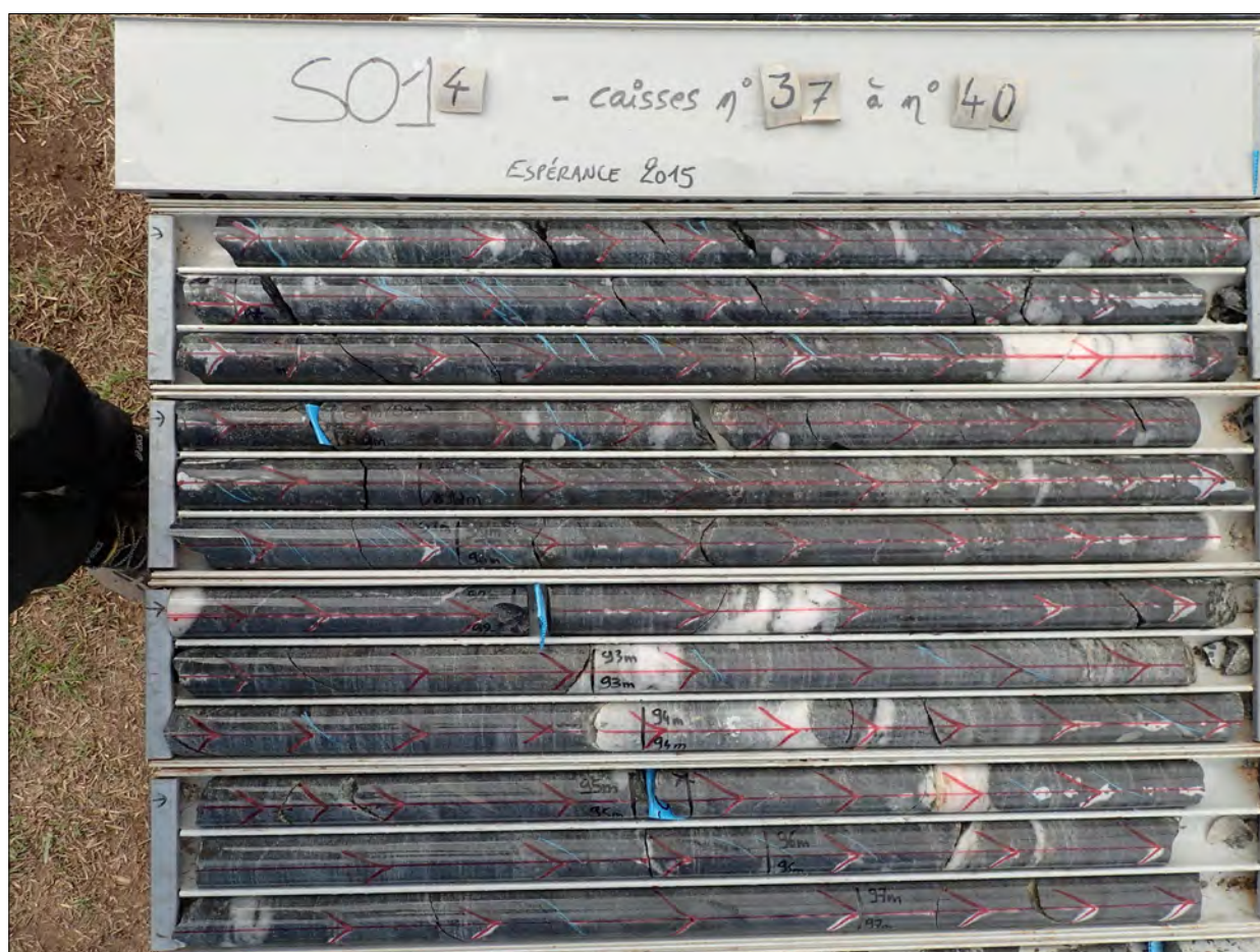
Photographie des carottes de sondage dans leurs caisses (sondage S014, caisses n°37 à 40)
