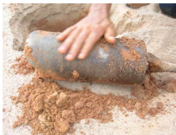
Prélèvement à la tarière après excavation des 50 premiers centimètres à la pelle, nettoyage du carottier pour éviter la contamination
