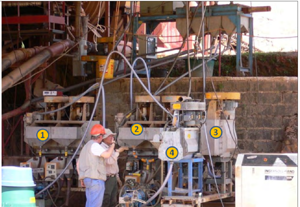
Installation pilote de flottation sur l'usine d'Espérance (CASPEO, 2009) 1) et 2) 2 bancs de 2 cellules de flottation Wemco de 60 L pour le dégrossissage 3) 1 cellule de flottation Wemco de 60 L pour l'épuisage 4) 1 banc de 2 cellules de flottation Agitair de 30 L pour le lavage
