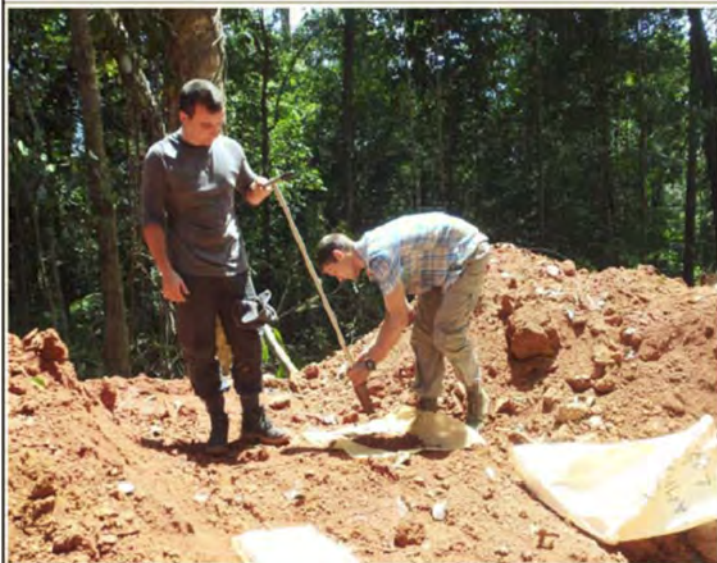
Photo C : Echantillonnage sur tas pour la tranchée T02.
