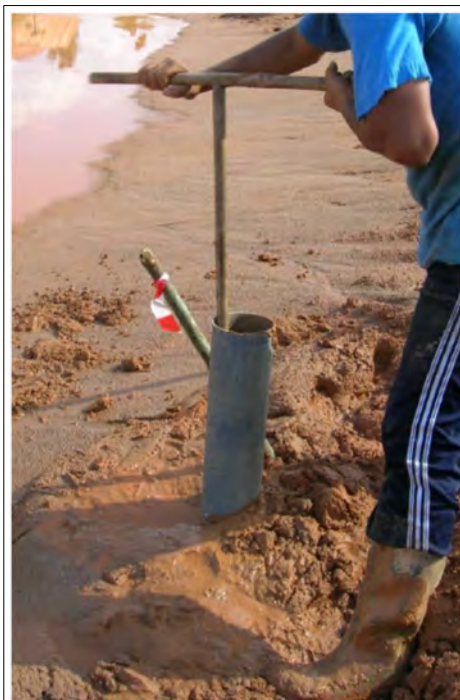
Prélèvement à l'aide du tubage dans les zones détrempées
