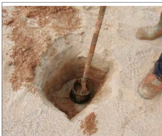
Prélèvement à la tarière après excavation des 50 premiers centimètres à la pelle, nettoyage du carottier pour éviter la contamination
