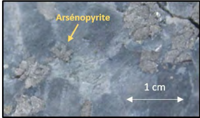
et d'arsénopyrite automorphe (forage: W-15-49, profondeur: 149.5m)
