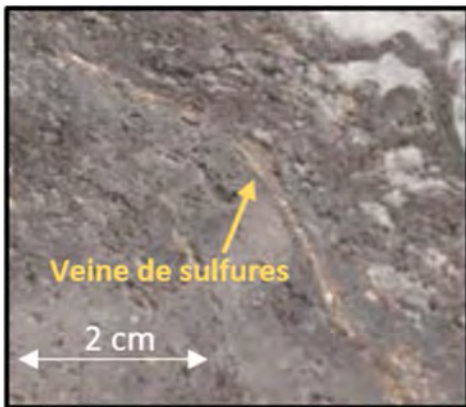
B. Veine de pyrite (forage: W-16-57 profondeur: 112.5m)
