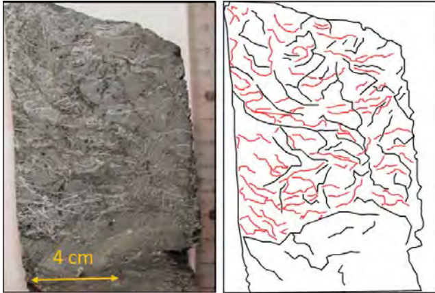
B. Carotte du forage W-15-49 montrant un premier stade tectonique ductile ( shear ) puis un deuxième stade de déformation cassante (brèche)
