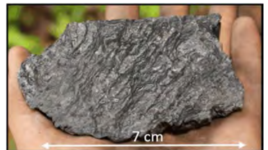
E. Veinules de graphite traversant une roche de nature pélitique (forage W-16-57, profondeur: 115m)
