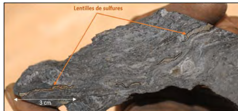
D. Dépôts de sulfures orientés dans le sens de la déformation ductile (forage: W-16-57, profondeur: 112 m)
