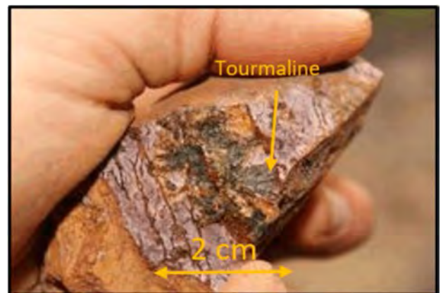
E. Tourmaline située au niveau d'un plan de fracturation (forage: W-15-38, profondeur: 48.5m)
