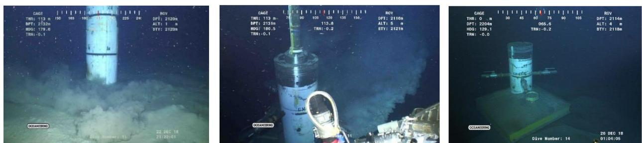
Figure 20: Jetting du Tube Conducteur.
