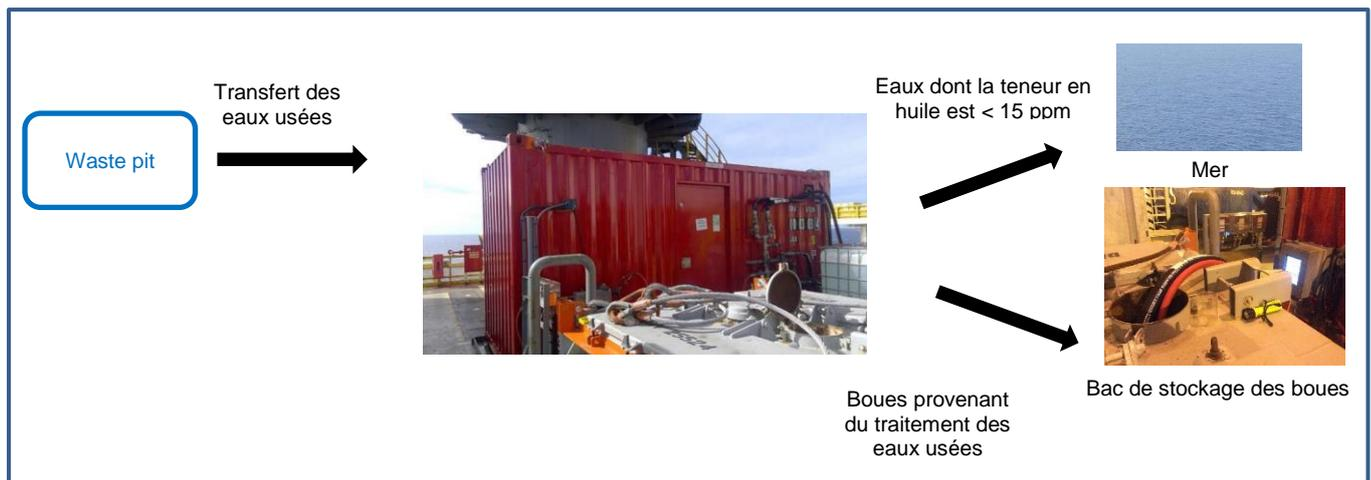
Figure 21: Représentation simplifiée du système de traitement des eaux usées
