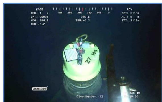
Figure 8: Tête du puits GMES-6 et protecteur à la fin des opérations
