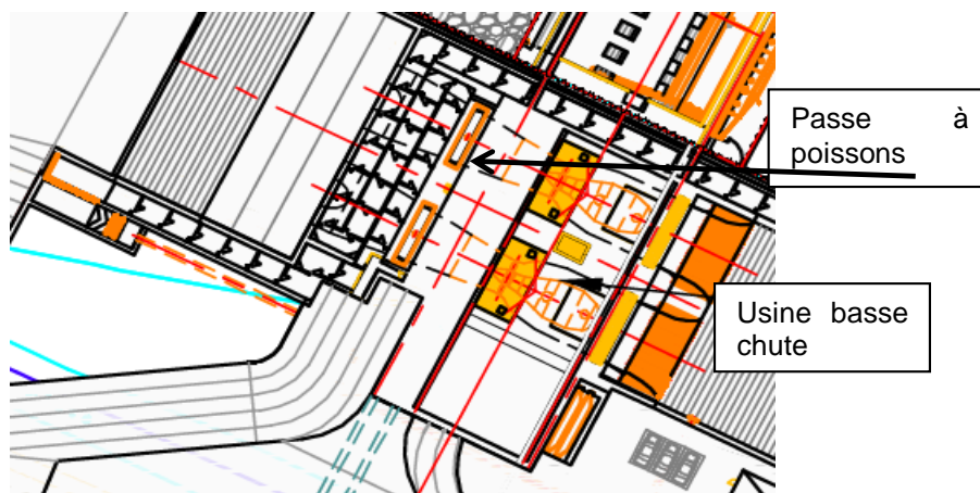
Fig. 10. Exemple de passe à poissons incorporée au génie civil d'une centrale basse chute
