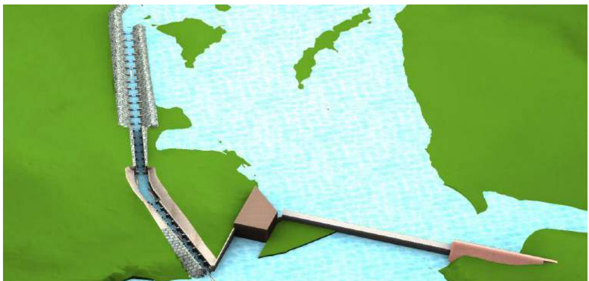
Fig. 2. Représentation de la passe mixte poissons-pirogues dans son environnement (hydrostadium, 2016)
