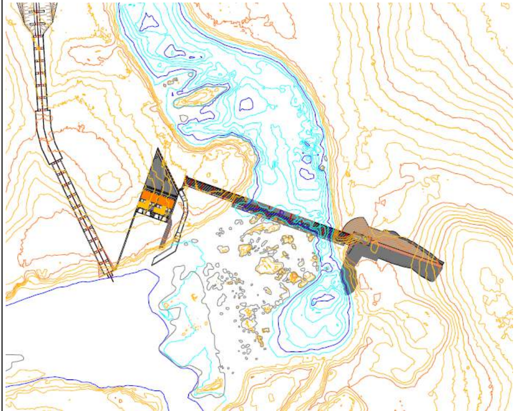
Fig. 16. Implantation du seuil avec bathymétrie du lit mineur
