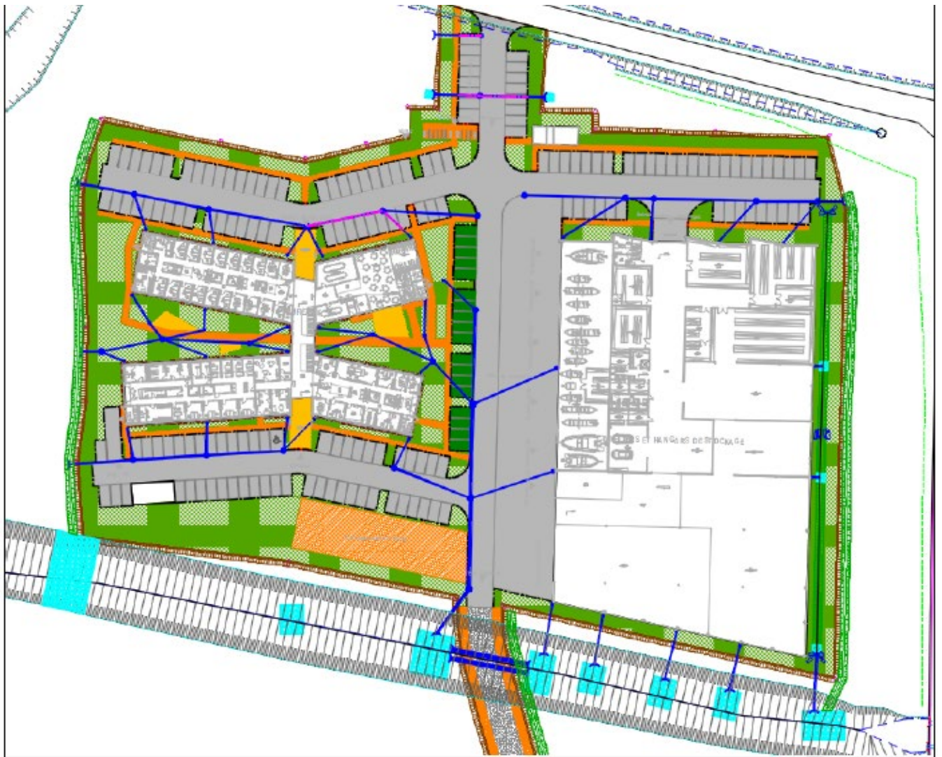
Figure 8 : Réseaux EP du projet (Source : Note hydraulique eaux pluviales, GTI septembre 2022)
