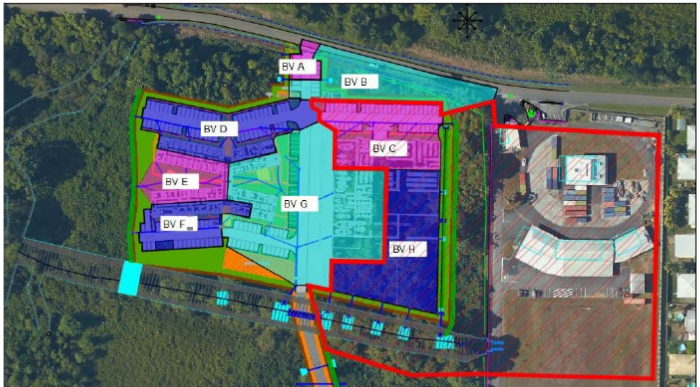
Figure 10 : Bassin versant de la future buse (BV en rouge) (Source : Note hydraulique eaux pluviales, septembre 2022)
