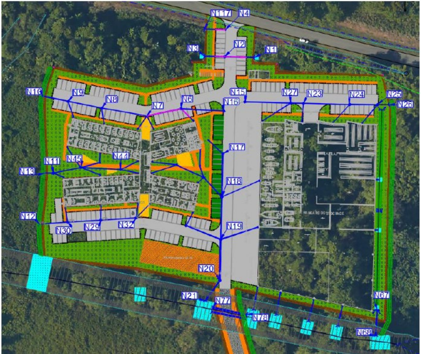
Figure 11 : Localisation des sections hydrauliques pour le réseau EP (Source : Note hydraulique eaux pluviales, GTI septembre 2022)
