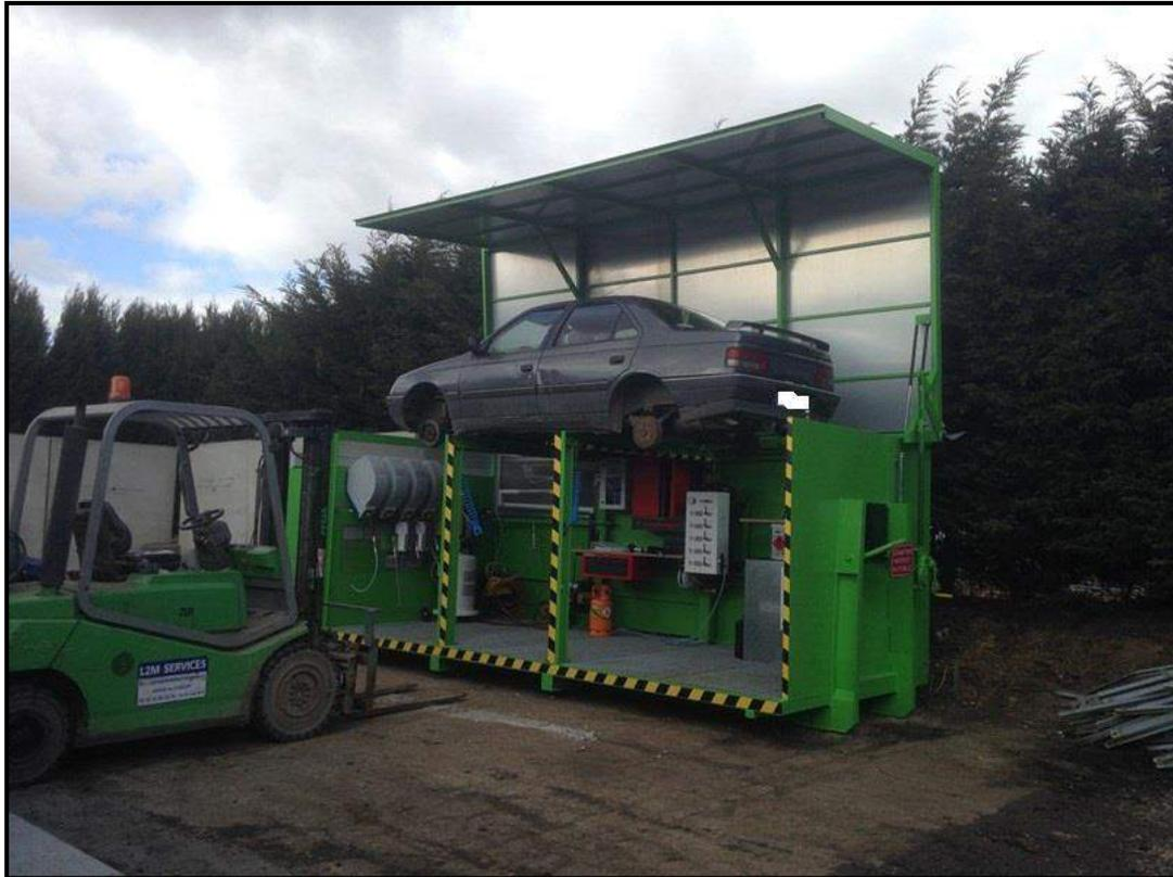
Figure 37 : Exemple d'installation de dépollution avec confinement des produits polluants
