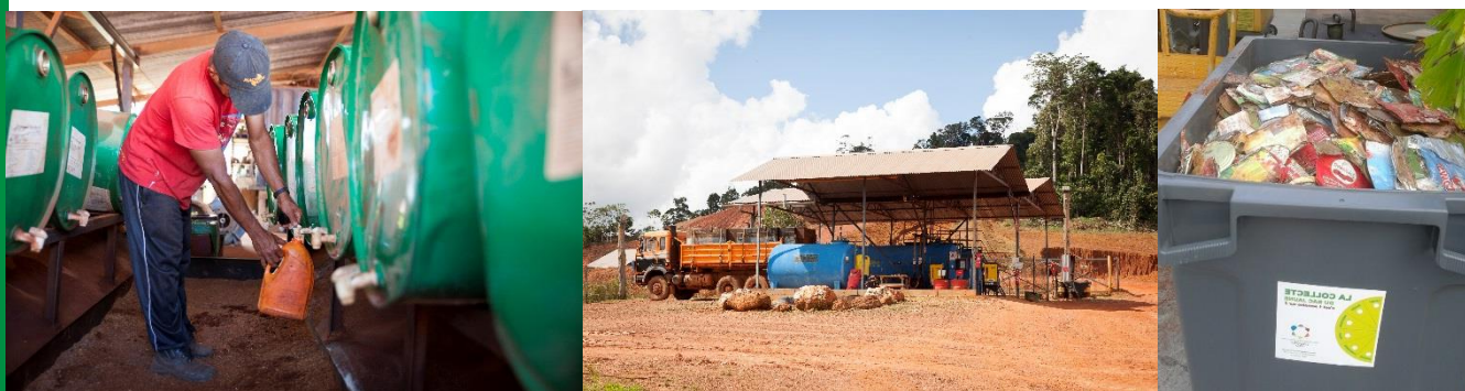
> De gauche à droite : stockage d'huiles sur rétention, citernes de gasoil à double paroi, conserves alimentaires compressées et recyclées
