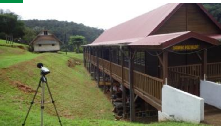
> Campagne de mesures environnementales, février 2016. A gauche, sonomètre à proximité des habitations de Saint-Elie. A droite, plaque de mesure des retombées de poussière.
