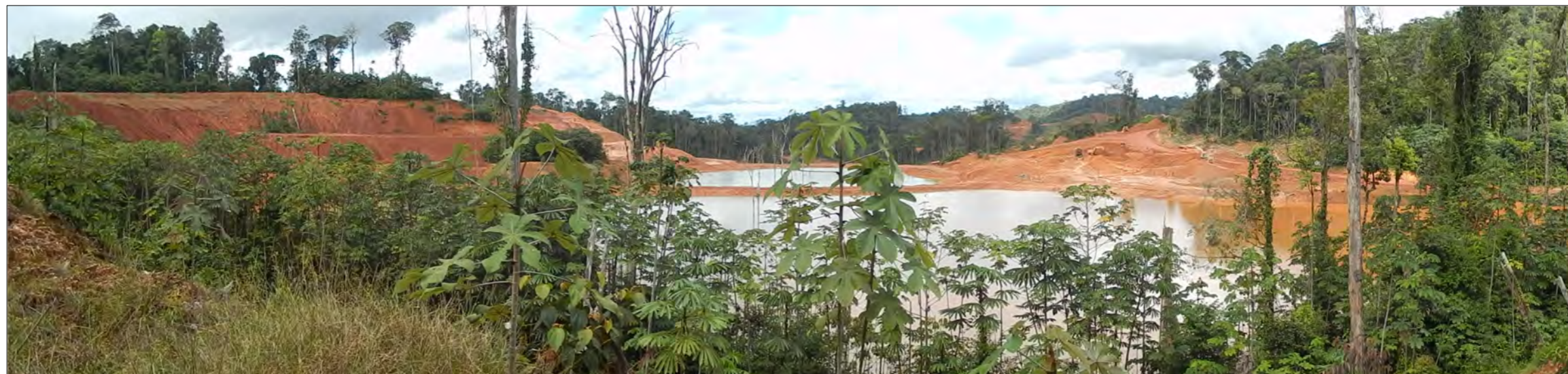
4) Vue sur la zone Sable depuis une ancienne versé à stériles revégétalisée : front d'extraction du minerai primaire saprolitique à gauche, bassins de décantation au centre, chantier éluvionnaire à droite en arrière plan (pelles, grille, wash plant)
