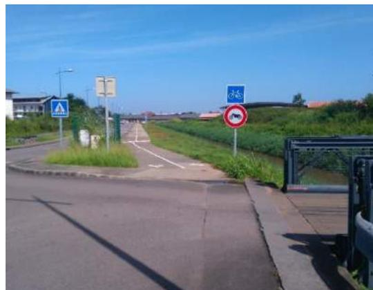
Le panneau C13 (cyclable) indique un aménagement réservé aux cycles. Le panneau d'interdiction aux deux-roues motorisés B9h est donc inutile (segment 31)
