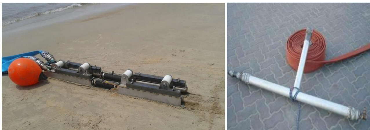
Figure 20 : Trencher de type « jet sledge » permettant l'ensouillage des câbles
