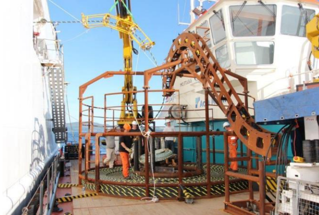
Figure 14 : Exemple d'un Spread de câble installé sur une barge - chargement de câble (Orange Marine)
