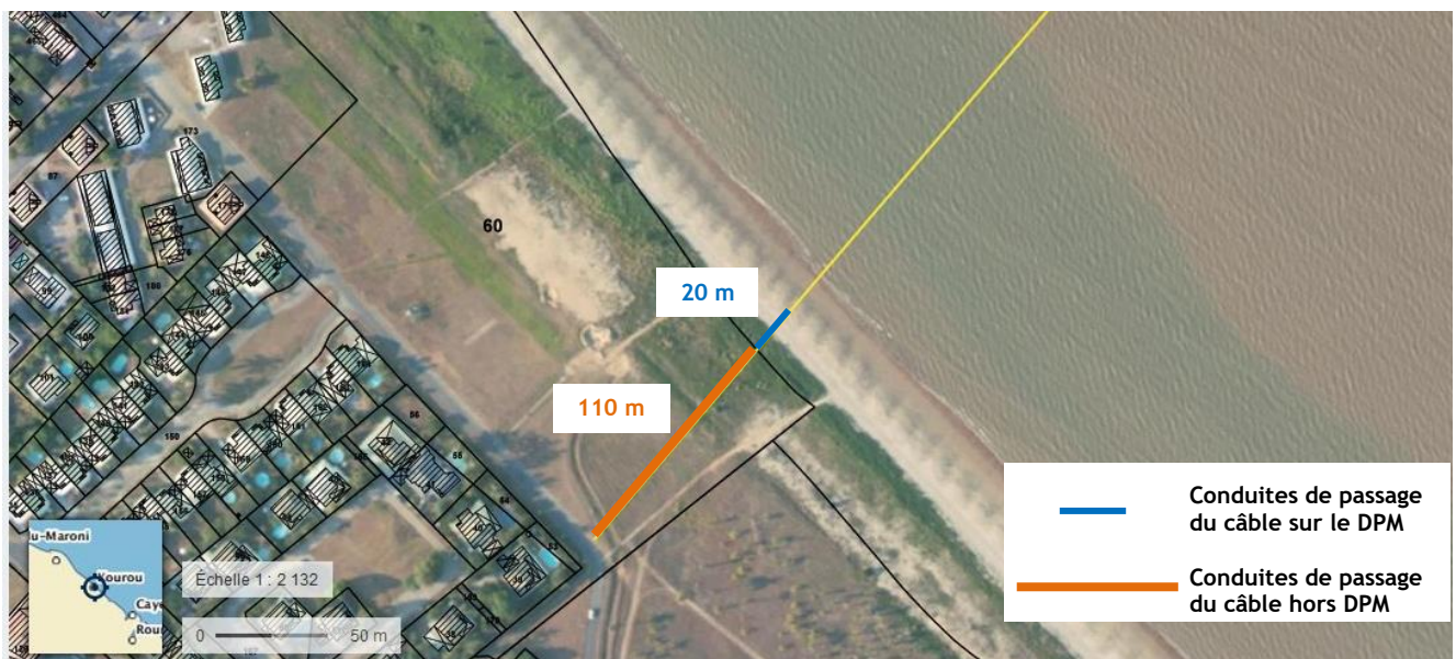
Figure 11 : Localisation des sections de conduites sur le DPM
