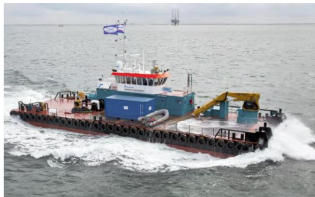
Figure 13 : Barge classique pour les eaux peu profondes pour les travaux d'atterrissage (Orange Marine)
