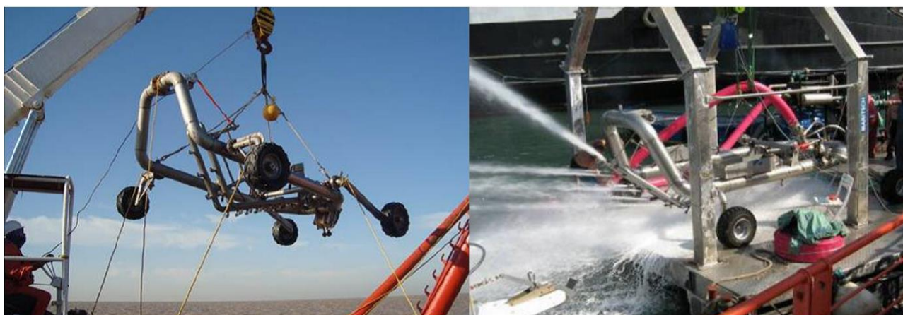
Figure 19 : Trencher de type « jet sledge » permettant l'ensouillage des câbles
