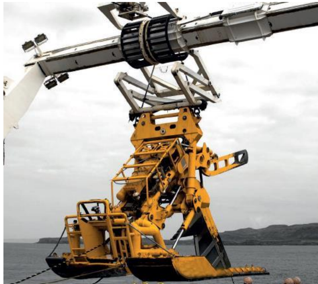
Figure 22 : Exemple de charrue tractée (Orange Marine)
