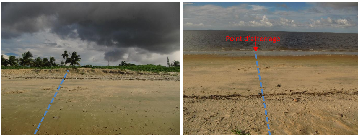
Figure 4 : Tracé du câble depuis le haut de plage jusqu'au point d'atterrage
