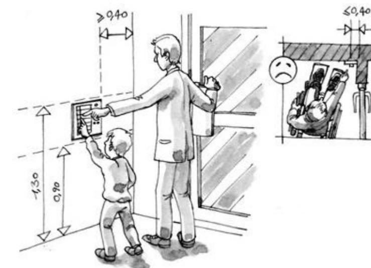
Schéma 3.3 - Positionnement des dispositifs de contrôle d'accès
