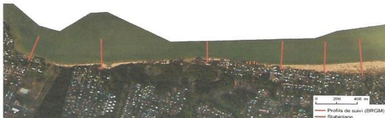
Implantation des profils de plages suivis dans le cadre de l'Observatoire de la Dynamique Côtière et du projet de Stabiplate – Plage des Salines
