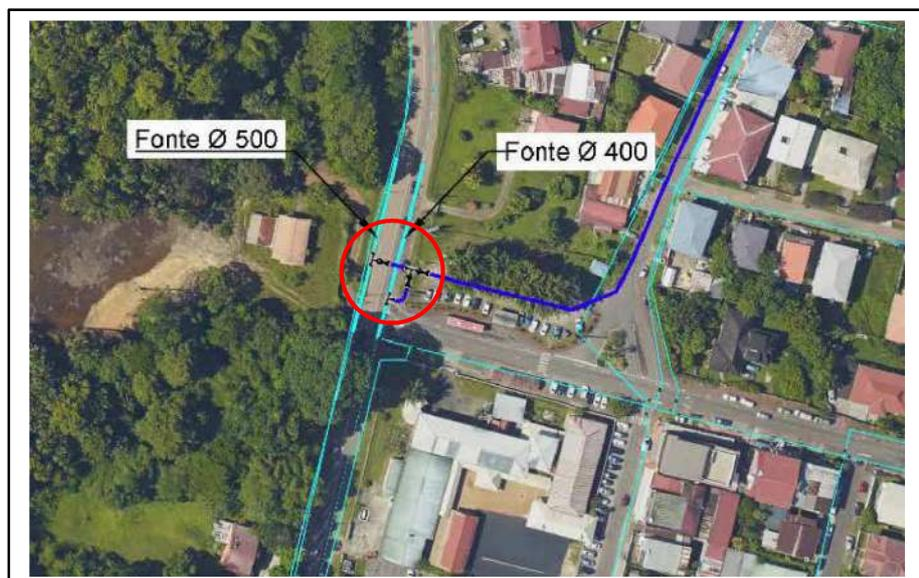
Figure 7 : Raccordement aux canalisations (DN 400 et DN 500) le long de la RN2 - SECOTEM
