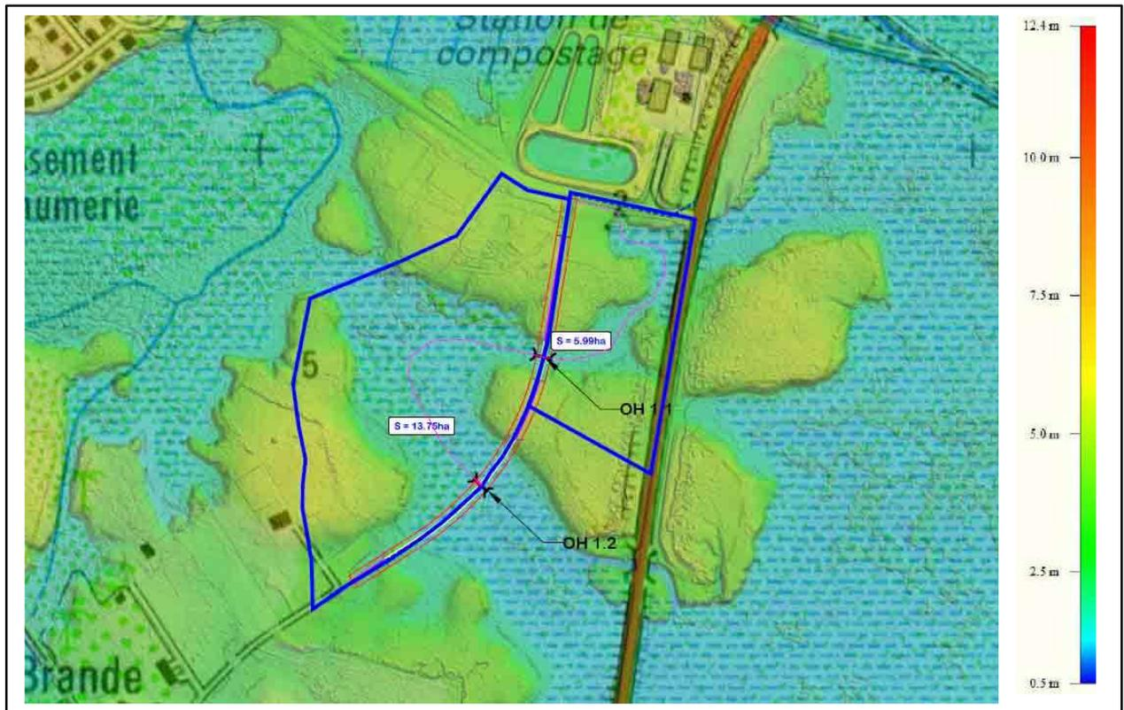
**Figure 80 : Bassins versants interceptés par la piste et la pose de la canalisation**
