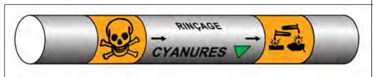
Exemple de marquage d'identification de canalisation contenant du cyanure en solution
