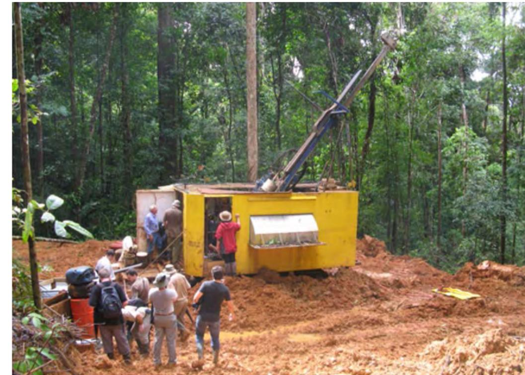
Illustration d'un sondage carotté d'estimation profond (>100 m), plate-forme de 10 x 10 m environ sondeuse lourde
